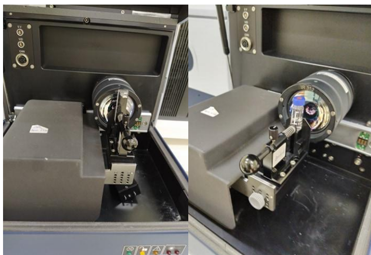
รูปที่ 8 แสดง Sample compartment ใน mode standard ที่ใช้ Quartz cuvette และขวดแก้ว vial
